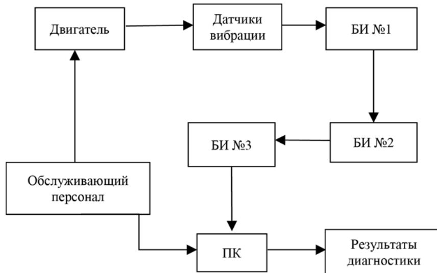
Рис. 1. Схема-эскиз ручной системы диагностирования вибраций двигателя БИ – блок измерений; ПК – персональный компьютер
