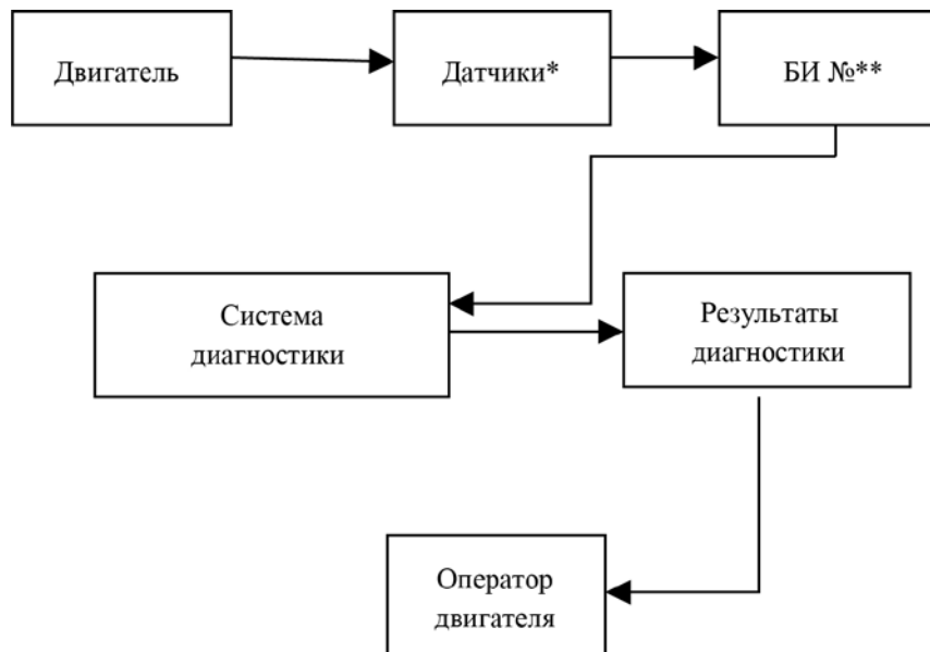
Рис. 4. Структура автоматической системы диагностирования
